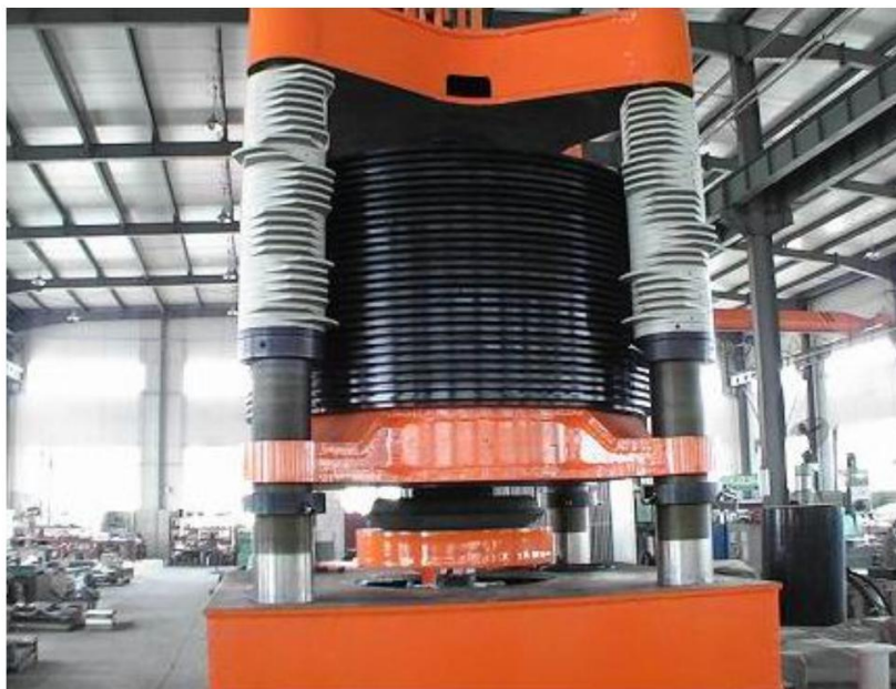
图 3-27 富力通达同青岛阿尔斯通合作研制出液压伺服油压减振器振动台
