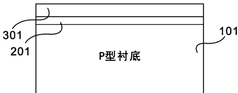
2013年7月3日, CN104282552A (US9553164B2) 公开了一种 IGBT 的制造方法, 其包括: 提供具有第一表面和第二表面的第一或第二导电类型的衬底; 在衬底的第一表面形成间隔的凹槽 13; 在凹槽内填充第二或第一导电类型的半导体材料以形成通道 14, 其中通道的导电类型与衬底的导电类型不同; **在衬底的第一表面 11 上键合形成第二导电类型的漂移区 15**; 基于漂移区形成 IGBT 的正面结构; 自衬底的第二表面 12 开始减薄衬底直到露出通道; 在通道和减薄后的衬底上形成背面金属电极 23。该方法对薄片流通能力没有特殊要求, 更不需要双面曝光机设备, 与现有的常规工艺兼容, 工艺简单、效率高。
