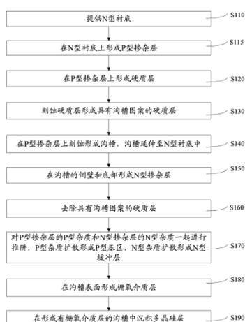
2013年7月31日,CN104347403B 一种绝缘栅双极性晶体管的制造方法，其特征在于：包括，提供第一导电类型的半导体衬底 101，该半导体衬底具有第一主面和第二主面，在第一主面上形成氧化层 102，第一导电类型为 N 型；在第一导电类型的半导体衬底的第一主面通过光刻工艺刻蚀有源区的氧化层和终端区域的氧化层，之后进行第一导电类型的离子注入；在第一导电类型的半导体衬底的第一主面上生成栅氧化层 401，具体的，首先在 800℃ ~ 850℃ 时干氧 5min，之后根据需要的氧化层厚度进行 H<sub>2</sub>-O<sub>2</sub> 合成氧化，再在 800℃ ~ 850℃ 干氧氧化 3min ~ 5min，最后在 1000℃ ~ 1250℃ 时 N<sub>2</sub> 气氛中退火 10min ~ 1000min，形成厚度为的栅氧化层；在栅氧化层之上淀积一层多晶硅层 402 用
