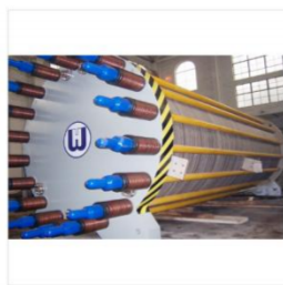
2-1000m 3 /h中压水电解制氢装置
