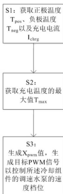
图 4-29 CN112895959A 直流充电控制系统的控制方法
