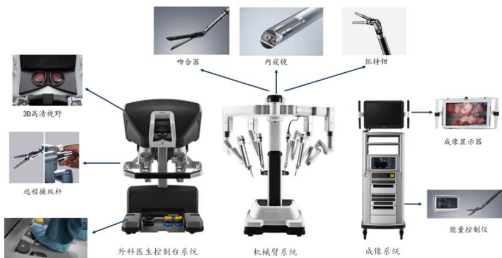
图 1 腔镜机器人主要系统和器械
